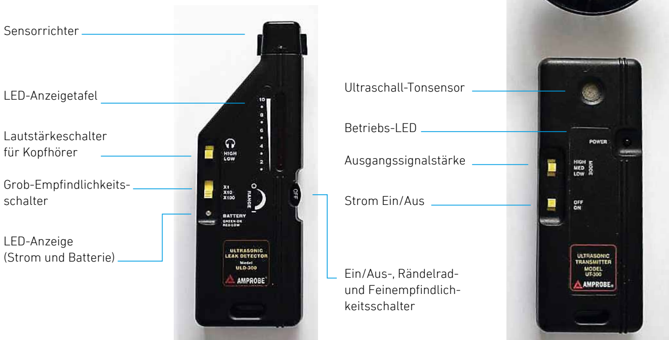
Abbildung 3.18: Aufbau des AMPROBE Ultraschallmessgeräts ULD-300/Quelle: [ULD08]
