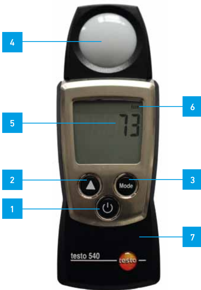
Abbildung 4.1: Luxometer „testo540“/Quelle [IPT16]
