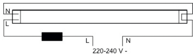
Abbildung 5.9: Veränderung der Schaltung bei Einbau von LED-Röhren in Leuchten mit vorhandenem EVG/Quelle: [IPT16]
